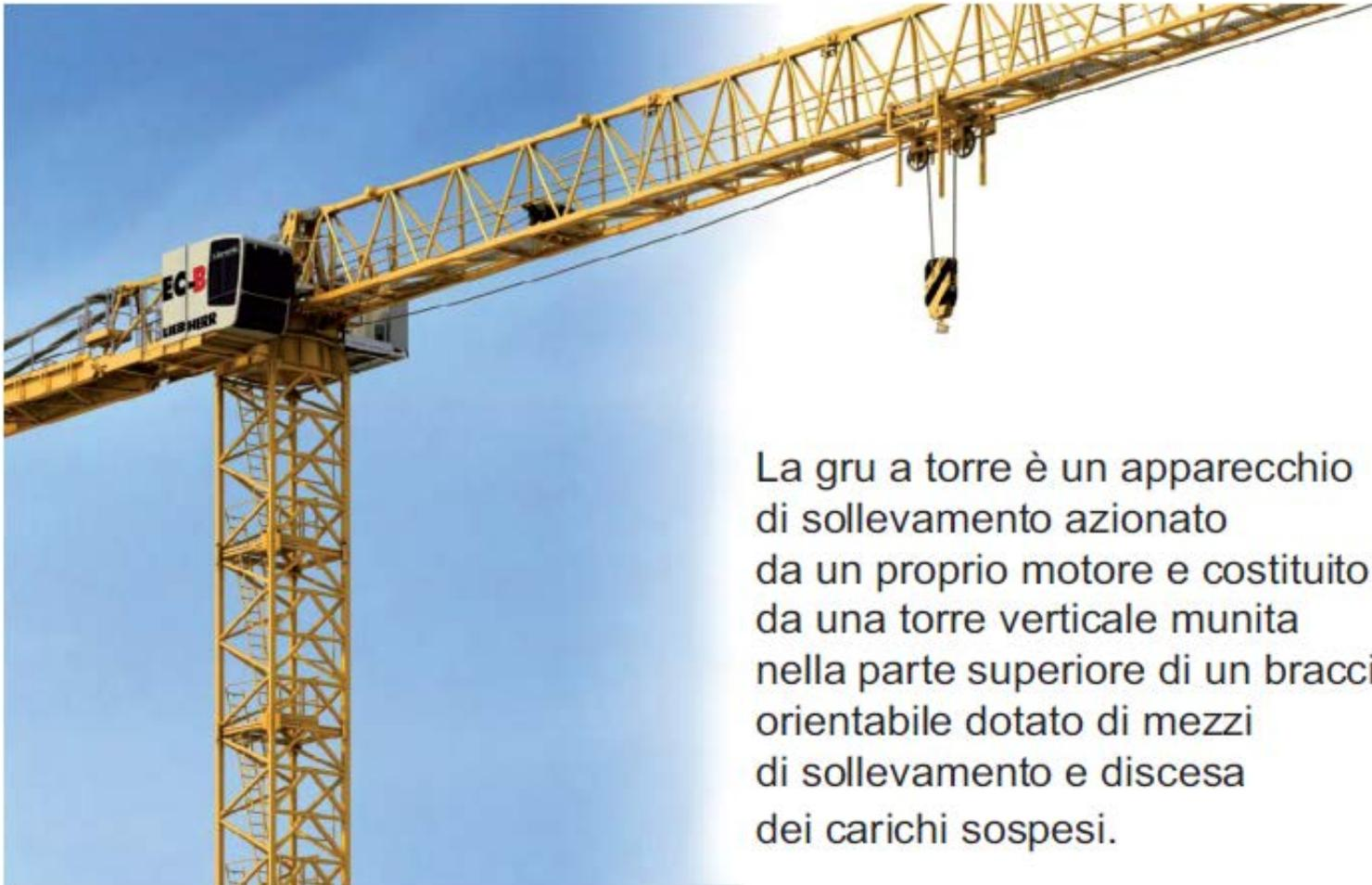
La gru a torre è un apparecchio di sollevamento azionato da un proprio motore e costituito da una torre verticale munita nella parte superiore di un braccio orientabile dotato di mezzi di sollevamento e discesa dei carichi sospesi.
