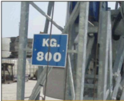
Sul **braccio** devono essere **posizionati** in modo ben visibile i **cartelli** indicanti la **portata** in funzione del diagramma di portata della gru.
