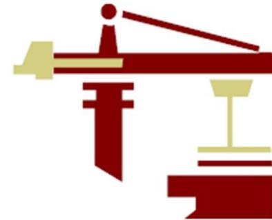
Nelle gru con rotazione in **basso la ralla** (meccanismo di rotazione) è posizionata sul **carro di base**. Il sistema stabilizzante è costituito da: **zavorra di base** e **controfreccia** (sistema di tiranti collegati alla cuspide).
