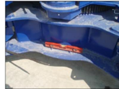
Gli **appoggi** generalmente sono **regolabili** in **altezza** e determinano la stabilità a terra della gru.
